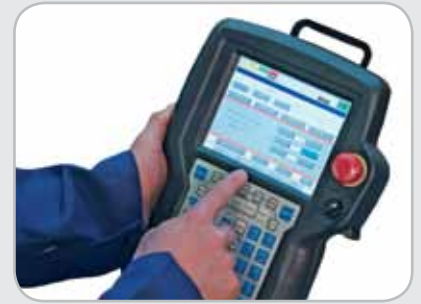
Подвесной пульт управления роботом отображает интерфейс KempArc Browser.
