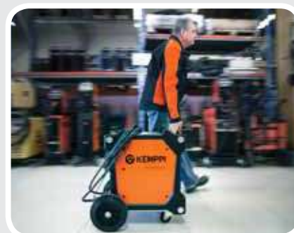
Батарея нагрузки ArcValidator — это универсальное портативное решение для проверки оборудования различных производителей.
