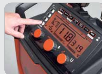
Модели Kimpact Adaptive (A) предлагают специальные функции, в том числе возможность установки мощности в зависимости от толщины листа, выбор присадочного материала и каналы памяти.
